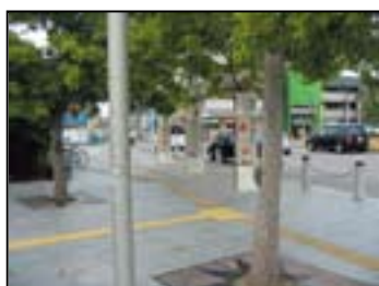
① タクシー乗降場付近 ・有効幅員は 3.5m 以上ある。 ・車道とは石柱とチェーンによる防護柵で分離されている。
