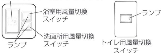
■急速に換気したいとき風量切換スイッチを右側に押すと、ランプが点灯し「強」運転に切り替わります。
