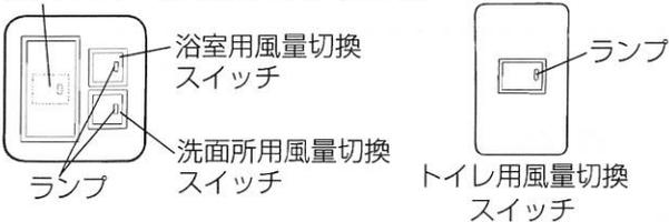
■急速に換気したいとき风量切换スイッチを右側に押し、ランプが点灯し「強」運転に切り替わります。
