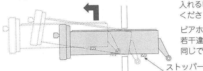
引き出しの奥の裏面にストッパーが付いていますので、上に持ち上げた後ひきだすと取り外せます。入れる時は、逆の手順で行ってください。
