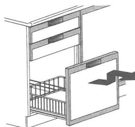
引き出しを15cmほどひきだして、手前を数センチ持ち上げてひきだします。その後、スライディングトレイを両手で持ち上げれば、取り外せます。
