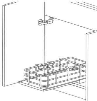
ビン立てを取り外す時は、まず手前にいっぱいまでひきだし、次に手前を数センチ持ち上げてひきだし、両手で持ち上げればはずれます。
