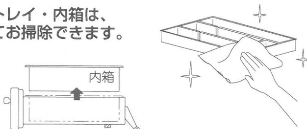
インナートレイ・ピアグリーンホーロー(HG)の引き出しの内箱(樹脂製)は、左図の様に上に持ち上げてはずし、丸洗いができます。
