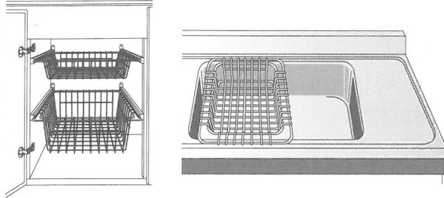
本体にセットして、ご使用していただく他、シンク内にセットして水切りカゴとしてもご利用いただけます。
