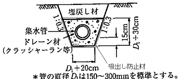
解図 6-1-2 地下排水工の構造例 6)
