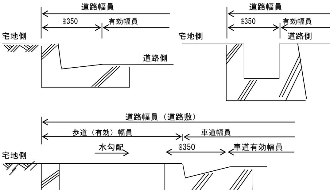
**【可変側溝の取扱い】**
