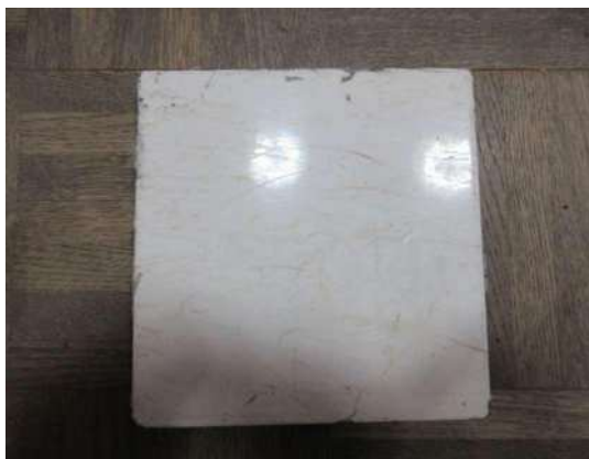
写真 3-1-237 塀の白色硬質タイル
